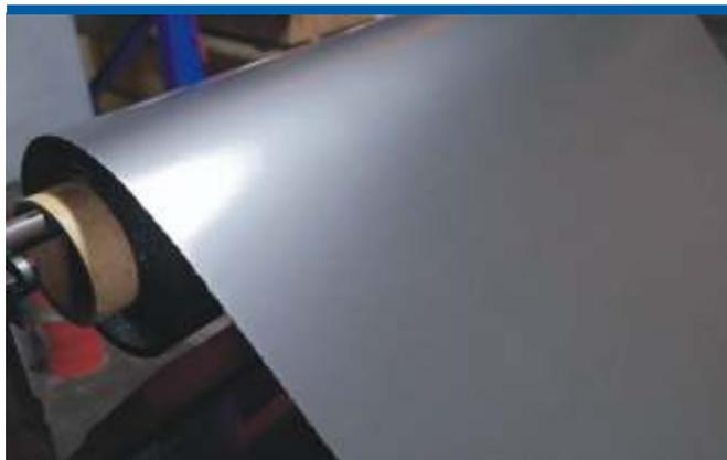
*Прокладочные листовые материалы предназначены для изготовления прокладок используемых для уплотнения фланцев и соединительных частей трубопроводов, арматуры, машин, приборов, аппаратов и резервуаров, используемых в газовой, нефтехимической, пищевой промышленности и коммунальном хозяйстве.*
