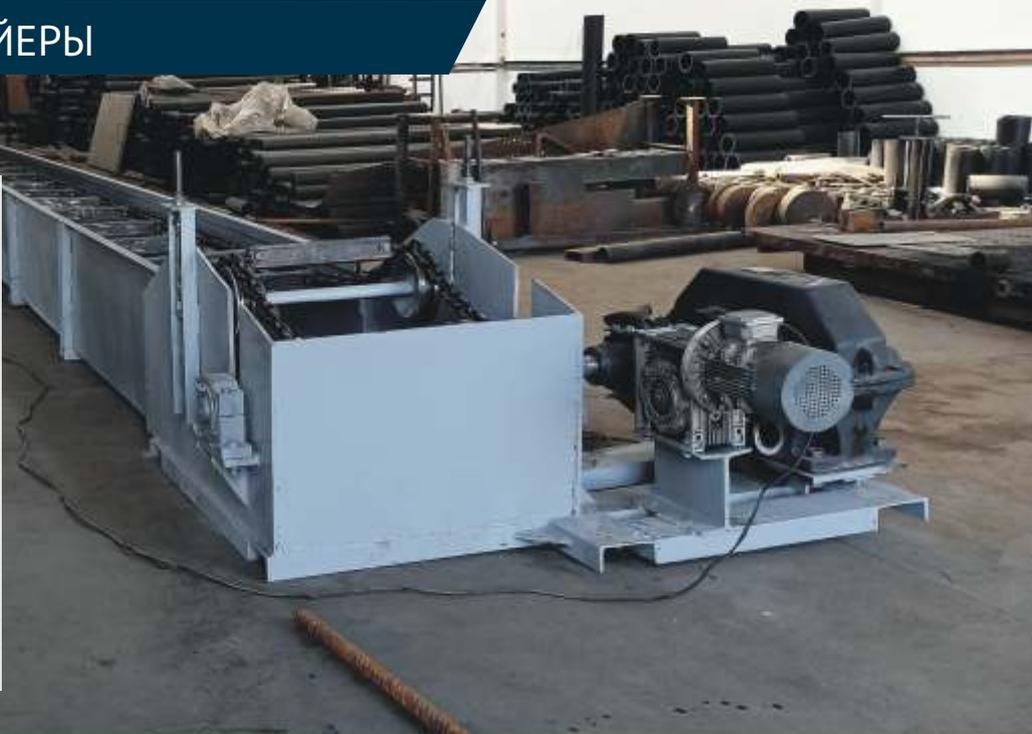
*Скребковые конвейеры – это механические устройства, предназначенные для транспортировки сыпучих и кусковых материалов с помощью скребков. Они обеспечивают надежное и эффективное перемещение грузов в различных условиях. Реализация скребкового конвейера для компании "BASALT WOOL" значительно улучшила эффективность производственного процесса.*
